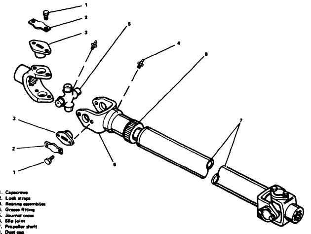
Figure 8-10. Propeller Shaft (810N37 & 10U49)
