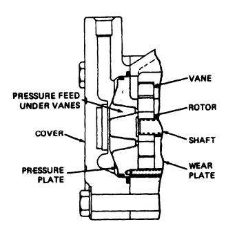
COVER END STRAIGHT VANE PUMPING CARTRIDGE SHOWN
