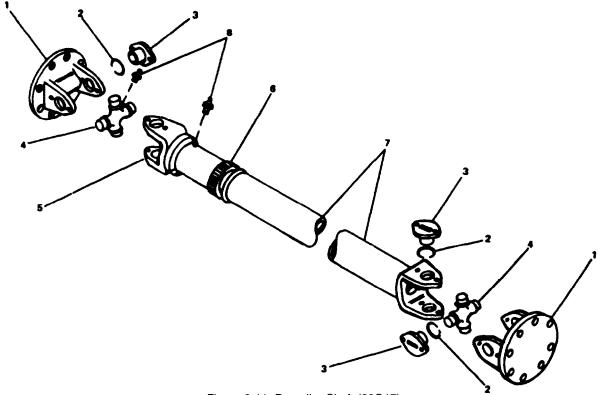
Figure 8-11. Propeller Shaft (20Q17)
