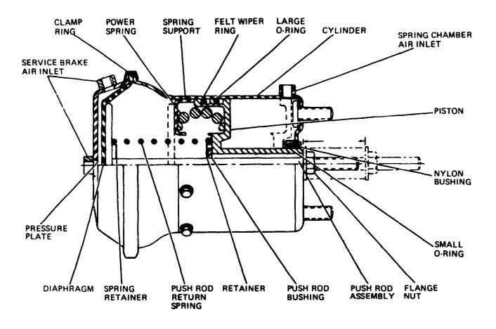
Figure 9D-3. Maxibrake Chamber 38Q18)
